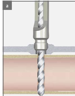
Mise en place de la vis Surfix® :
