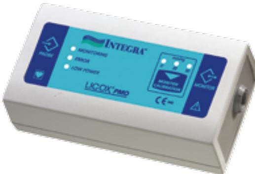
Le boîtier Licox PMO est un système d'interface entre la sonde Licox Ref. CC1P1 de mesure combinée oxygène/température et le moniteur patient.
